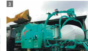
ラッピング作業と同時に次のバールを成形
