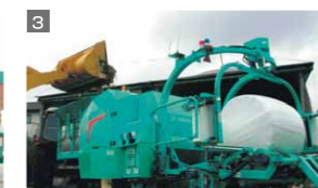
ラッピング作業と同時に 次のベールを成形
