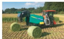
細断型ホールクロップ収穫機
