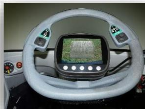
機体後部に2台の小型カメラを装備。ハンドル中央の液晶モニタで、ロールの排出状態等が確認できます。
