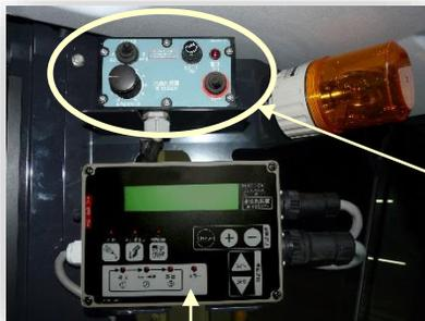
乳酸発酵を促進する乳酸菌を添加することで、より良質なサイレージに仕上がります。乳酸菌を刈取りと同時に自動的に噴霧する添加装置を標準装備しています。
