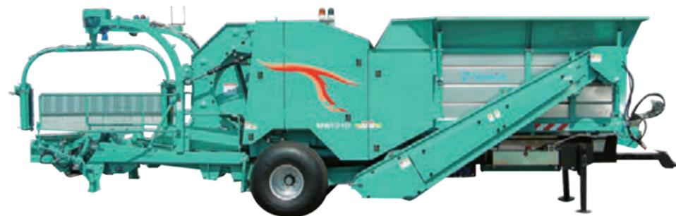
型式 MW1010H 用 MW1010-CC オプションでクリーニング装置を用意しています。機体からの飼料こぼれによるロスの削減が図れます。
