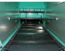
ホッパ底のコンベアでベール成形部へ作物をスムーズに送り込みます。ホッパ量は 2.5 m<sup>3</sup> (ベール約 2 個分) が入り、ローダ等による作物の投入が効率よく行うことができます。
