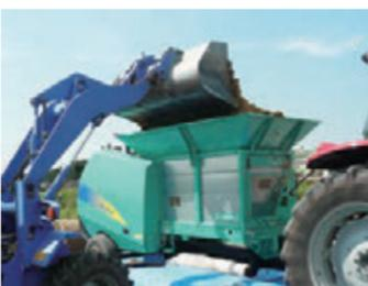
リモコンが標準装備され、ローダからの遠隔操作で定置でのワンマン作業が行えます。
