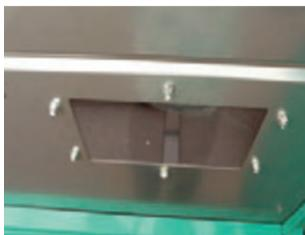
ホッパ前方と側面には確認窓を設け、ホッパ内部の飼料の残量の確認が行えます。
