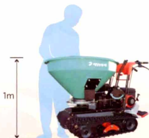
投入高さは地上1mと 低く肥料の投入がラク ラク
