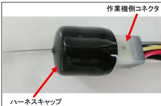
泥などが入ると、コネクタ内の防水用ゴムの潤滑が低下し、コネクタの接続が固くなります。
