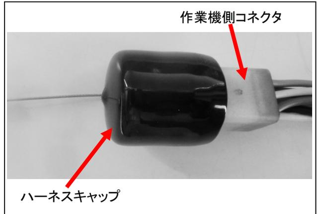
泥などが入るとコネクタ内の防水用ゴムの潤滑が低下し、コネクタの接続が固くなります。泥などが入った場合は、エアースプレーで掃除し、綿棒などで防水用ゴムにシリコングリスを塗布してください。
