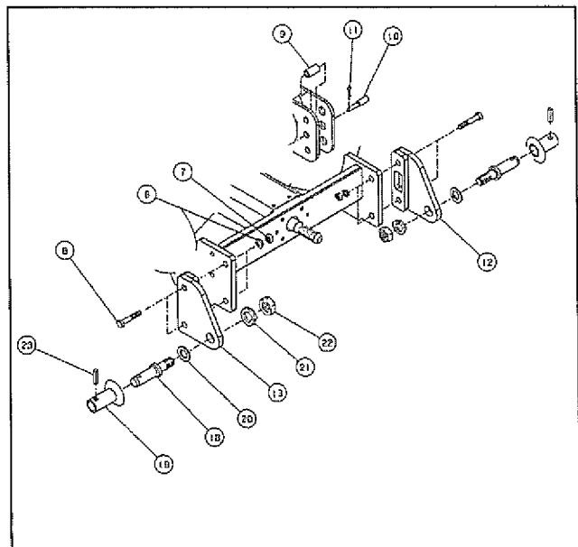
[5] 本機フレームに付属の日農工標準オートヒッチ用スタンドを装着すると、日農工標準オートヒッチ0・II用部品の取付けが完了です。
