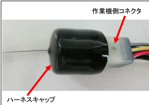
泥などが入ると、コネクタ内の防水用ゴムの潤滑が低下し、コネクタの接続が固くなります。
