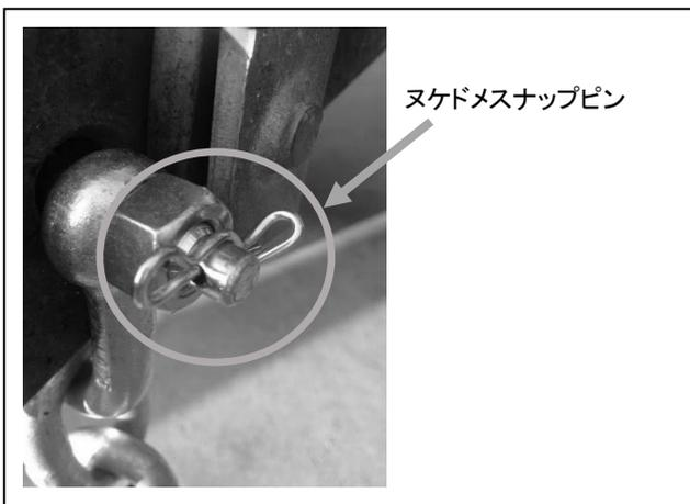
ヌケドメスナップピンは反時計回りに回しながら抜くと抜けます。
