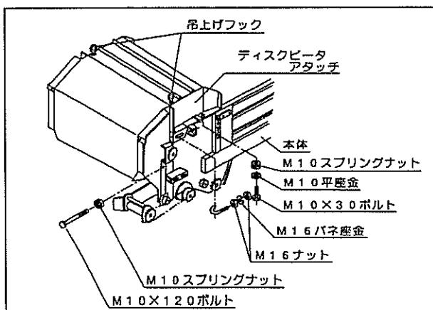
[3] ボルトを締め付け後、ディスクビータアタッチを持ち上げているフロントローダ等を外してください。
