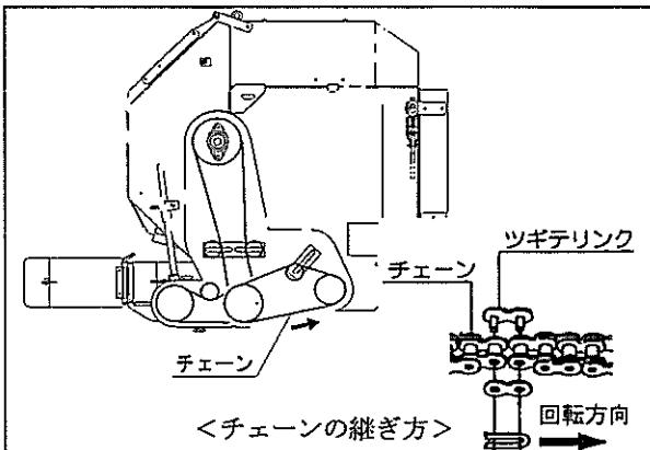
[5] アイドラスプロケットのボルトを緩め、アイドラスプロケットを押し、チェーンを張って再度ナットを締めてください。チェーンの張りは、中央部を指で軽く押さえて 5 ~ 15 mm のあそびがあるよう調節してください。
