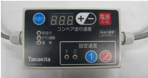
電源 [入/切] を押し、コンベア送り速度の「+/-」のボタンを押すと、送り速度調整ができます。[+] を押しと表示数値が増加して送り速度が速くなり、また [-] を押しと表示数値が減少して、送り速度が遅くなります。
