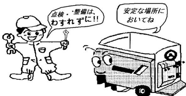
(4) 点検・整備は加熱部分が冷めてからマフラやエンジンなどの加熱部分が十分に冷めてから点検・整備をしてください。守らないと火傷する恐れがあります。
