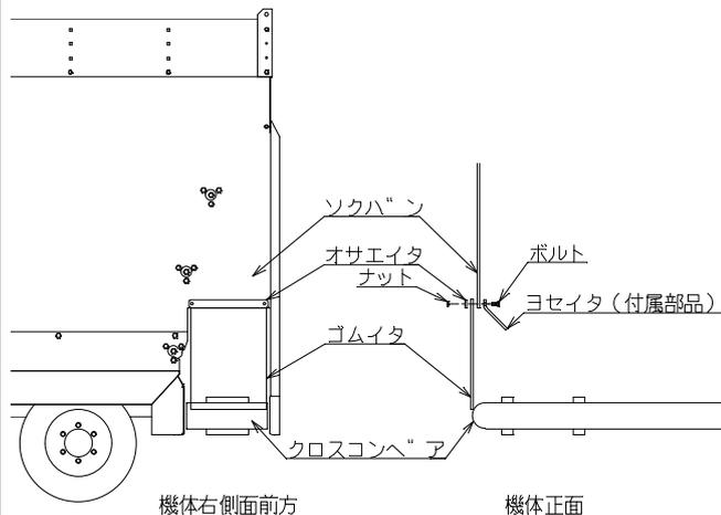
排出口のゴムイタ、オサエイタと共締めして取り付けてください。
