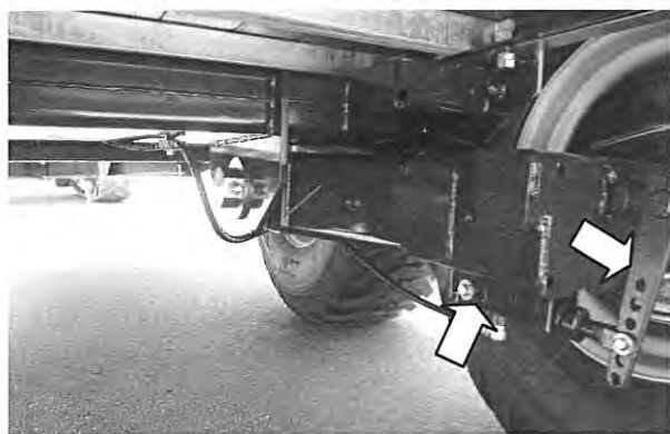
マニアの油圧シリンダとブレーキ部分
