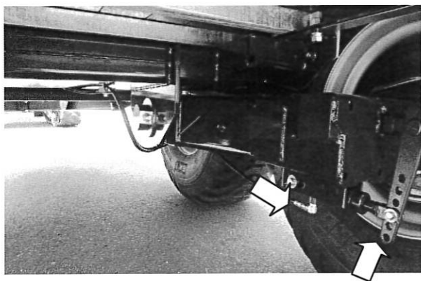
マニアの油圧シリンダとブレーキ部分
