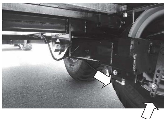
マニアの油圧シリンダとブレーキ部分
