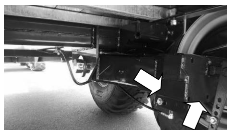
マニアの油圧シリンダとブレーキ部分
