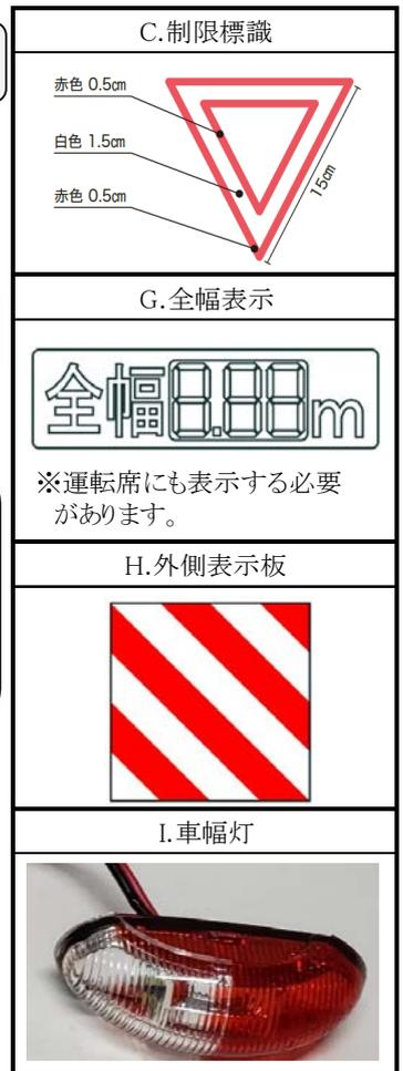
※1 トラクタの灯火器類が作業機の最外側から40cm以上ある場合、反射器が必要になります。しかし、弊社の外側表示板は反射材を含んでいるため、反射器は取付け不要です。
