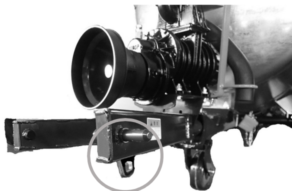
作業機へのチェーンステー溶接例 (S-1430)
