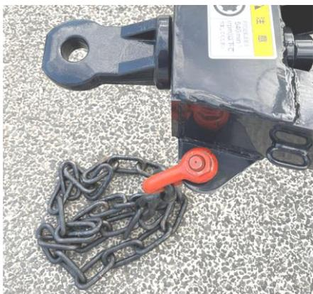
②セーフティチェーンをトラクタのドロワー部に回しかけトラクタから外れないようにします。
