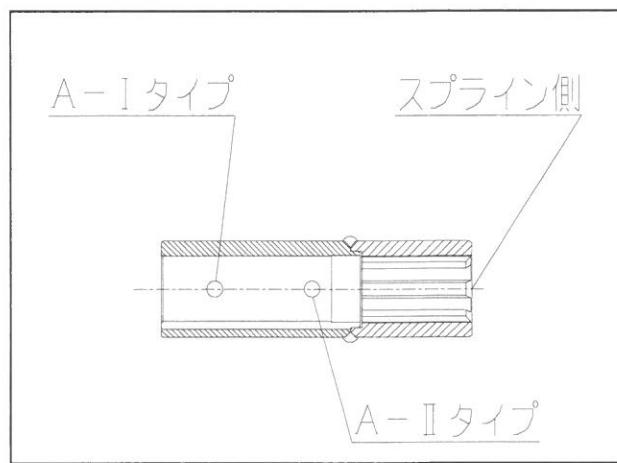
ジョイントシャフトとスライドシャフトとの固定穴位置は図のようにA-I、A-IIタイプによって違いますので、お持ちのオートヒッチに合った穴位置にボルト8×60で固定してください。
