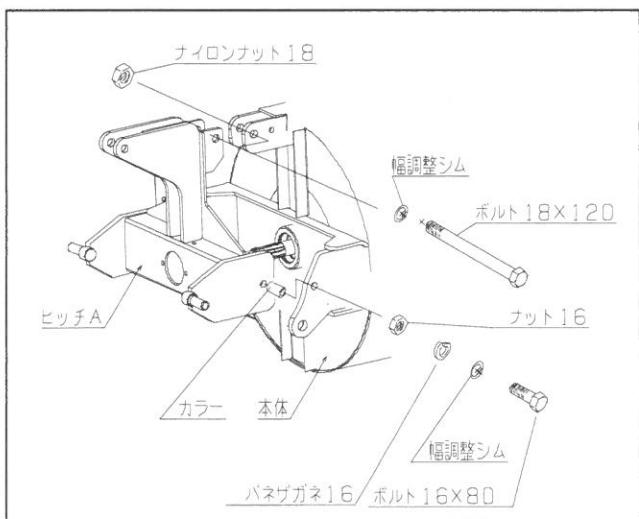
[3] ベアリング、シャフトカラー、ジョイントシャフトをスプラインシャフトに通しながら、図のようにヒッチAに固定してください。
