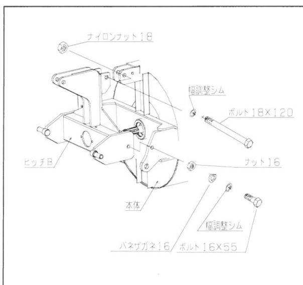
[3] ベアリング、シャフトカラー、ジョイントシャフトをスラインシャフトに通しながら、図のようにヒッチBに固定してください。(注:キーは忘れずに入れしてください。)
