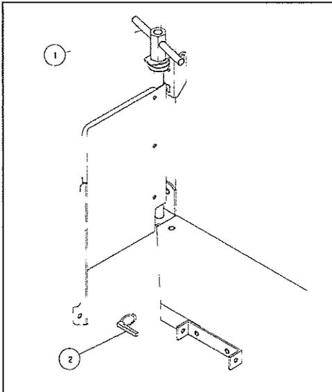
・②リンチピンで固定する時は、キセイイタが全閉の時、リンチピンを通して固定してください。
