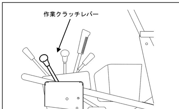
作業クラッチレバーを前方に倒すと、クラッチが「入」となり、タテビータが作動します。
