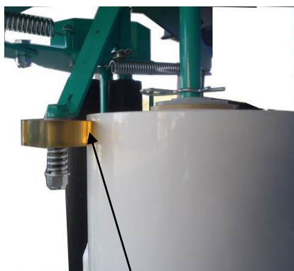
フィルムとローラを密着させ テンションをかける(ダブル側)
