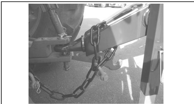
②セーフティーチェーンをトラクタのドロワー部に回しかけトラクタから外れないようにします。
