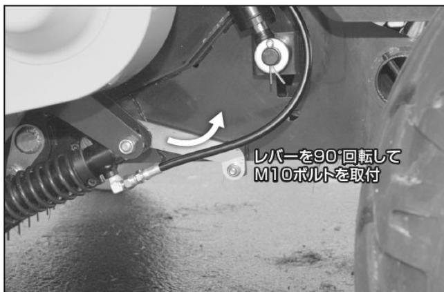
(3) トラクタの油圧レバーを操作してナイフフリーシリンダを完全に縮めてください。
