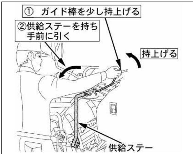
6. 供給ステーを開いた状態で左株元フレームと左搬送ケースに頭付きピンとスナップピンを取り付けて供給フレームを固定します。
