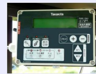
ネットの巻数設定が簡単に行える他、電子カウンターやエラーメッセージが表示され、運転席で容易に操作・確認できます。
