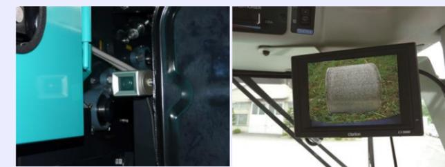
機体後部に2台の小型カメラを装備。バックモニタでロールの排出状態が確認できます。
