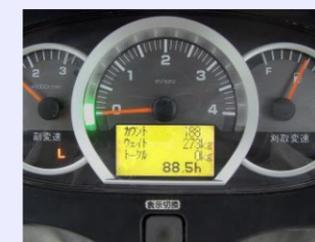
収穫時にロールバールの質量が圃場で測定でき、ロールの個体管理、収量管理が効率的に行えます。
