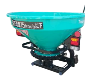
BC2001 ホッパ容量200ℓ 手動開閉シャッタ
