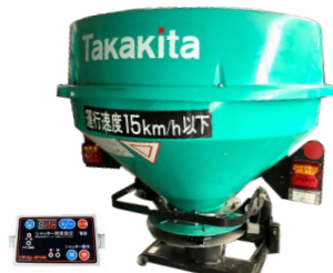
CC3531D ホッパ容量350ℓ 電動開閉シャッタ
