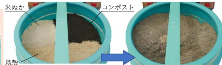
攪拌アジテータにより比重の異なる散布物の簡易混合ができますので、複数の肥料を一度に散布できます。低速回転の攪拌なので肥料の粉碎が抑えられます。(CCシリーズ)
