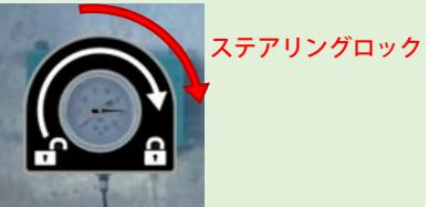
車軸ステアリングのシリンダと連動した、圧力ゲージを装備し、ステアリングロックのオンオフをトラック内よりゲージにて確認できます。
