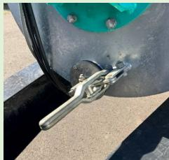
スラリーの飛散を防止し、環境に配慮した下方散布装置を標準装備。
