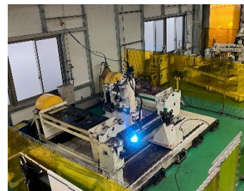
溶接ロボット
